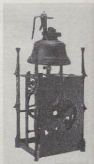
FIG. 8. — Horloge à poids, fer, de type gothique, à une aiguille et à un réveil (nr. inv. NM 7687).
